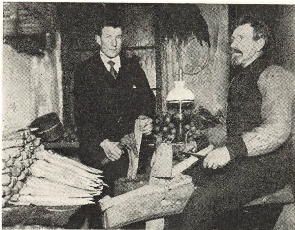
Tilvirkning af Tøjrepæle. Gaardejer Hans Jensen i Løgager Anelund laver Tøjrepæle. Manden sidder paa sin Tællehest (»Bondstole«) og tilskærer en Tøjrepæl med en »Bondkniv«. Hans Karl tilhugger en Tøjrepæl paa en »Hugknop« med en »Skotøksek«. Til venstre ses en Bunke Tøjrepæle. (Foto: S. P. Petersen.)
