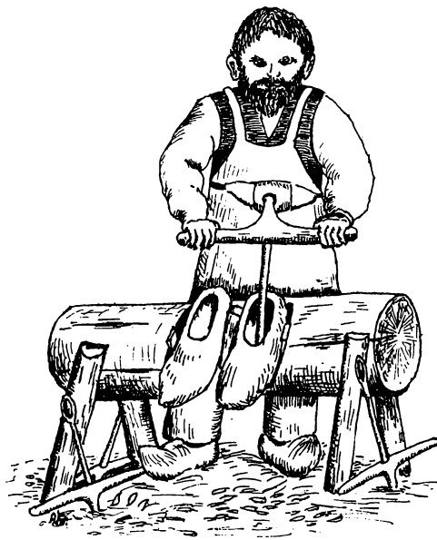
Træskoene er fastkilet i hulstolen , og de tildannes med buljernet .
