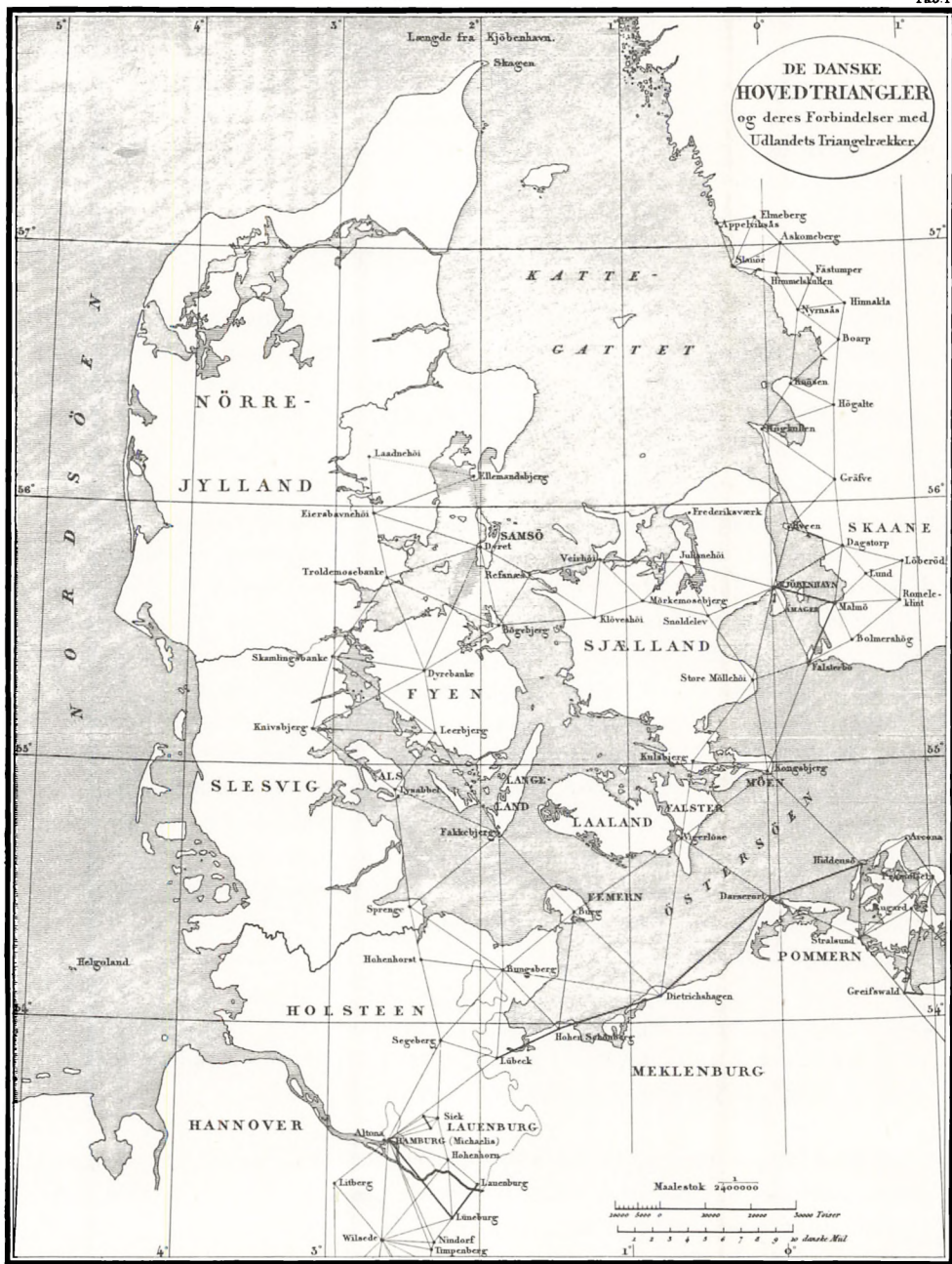
Reproduktion af Tab. I i C. C. G. Andræ: Den danske Gradmaaling, Bind 1 , der viser De danske Hovedtriangler og Deres Forbindelser med Udlandets Triangelrækker .
