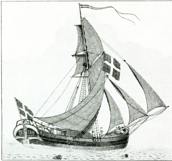
Evert »Fru Marie«, bygget i Sonderho 1793, forlist 1807. Everterne var smaa, fladbundede Sejlskibe med høj Bagstavn. Særlig mange af Amtets Skibe var Everter. (Kromann: Fanos Hist.).
