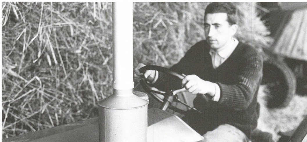
Kongskildes gnistslukker type K5 på en dansk Bukhtraktor i en lade.
