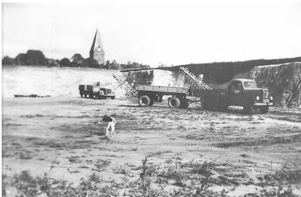
Johannes Jensens sandgrav vest for Sønderby 1953-1956. På billedet ses to lastbiler, der henter sand og to transportører, der hælder sand op i lastbilerne. I baggrunden ses Møgeltønder kirkes tårn. Foto: Erich Jensen.
