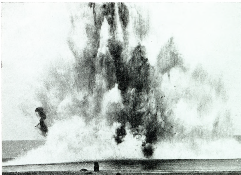
Virkningen af 1 Ton Sprængstof i 10 Miner fordelt i „U. 20“. Vandsøjleens Højde er ca. 300 Meter.
