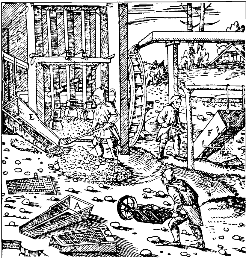
Saksisk stampemølle til knusning af jernerts. På en krudtmølle foregik knusning af trækul på en tilsvarende måde. Træsnit fra 1500-tallet.
