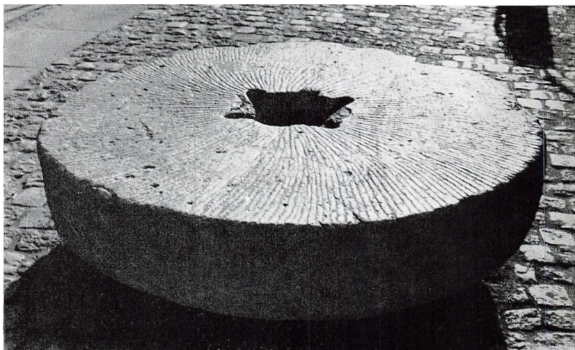
Kværnsten opstillet i Lyngby overfor møllerne. Det stråleformede mønster, bildningen , ses tydeligt. Det er en løber med undersiden vendt opefter. Foto forf.
