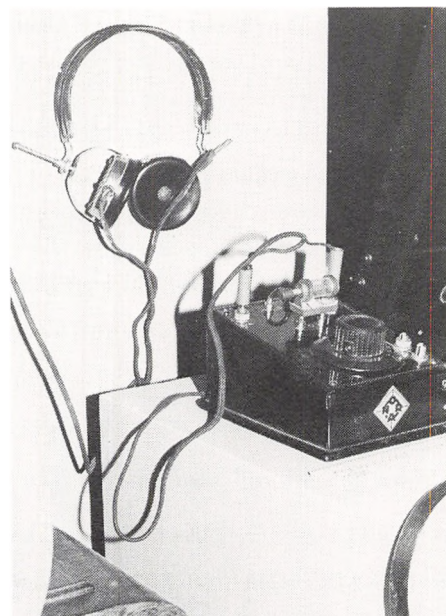
Krystalapparat fra 1930. Det centrale »organ«, krystaldetektoren, ses midt på pladen. Den store knap er til drejekondensatoren, der »fanger« de enkelte sendere. NM's udstilling i Brede 1985. Foto forf.
