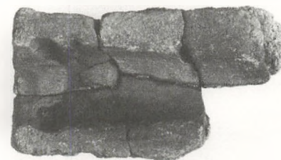
Tværsnit af den ene halvdel af en brugt støbeform fra Galgedil, hvor formens forskellige lag kan iagttages. Foto: D. Gramtorp.
