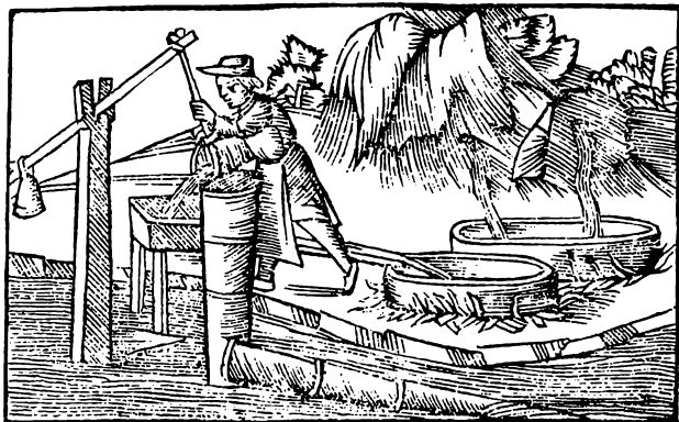
Saltøne. I sit værk om de nordiske folks historie fra 1555 gengiver Olaus Magnus dette billede af saltudvinding ved inddampning af havvand. Ilden flammer lystigt under ønene, der kan have lignet dem der har givet navn til det bornholmske Saltøne.
