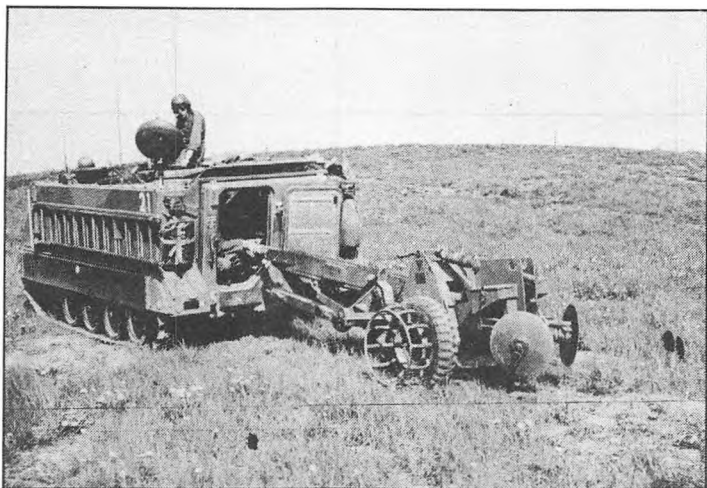
Pansret mandskabsvogn m. mineudlægger til PM M/75 (BAR-mine).
