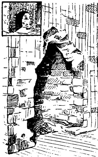
Normannisk kamin i The Tower i London fra anden halvdel af 11. årh. Afrækket sker gennem en røgkanal, der går skråt ud igennem muren bagtil. Den lille tegning øverst viser kaminens efter alt at dømme oprindelige udseende.
