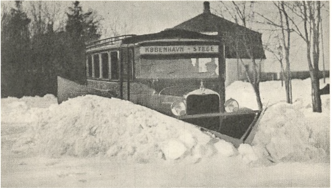
Ved Hjælp af den norske Sneplov »Skræp« kan Rutebilerne bane sig Vej gennem meterhøjt Snelag. Her et Billede fra København-Stege Ruten i Is- og Sneperioden 1928-29.
