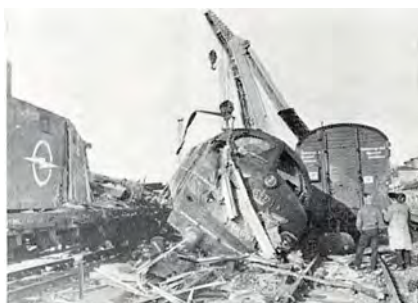
Så snart det blev lyst, var DSB's kraner og hjælpvogne på stedet og påbegyndte det omfattende oprydningsarbejde.
