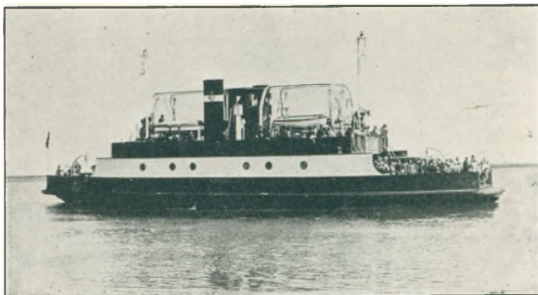
Motorfærgen „Nordby“. Indsat i Farten 1. Juli 1931. Kan overføre 16 Biler og ca. 500 Passagerer paa en Gang.
