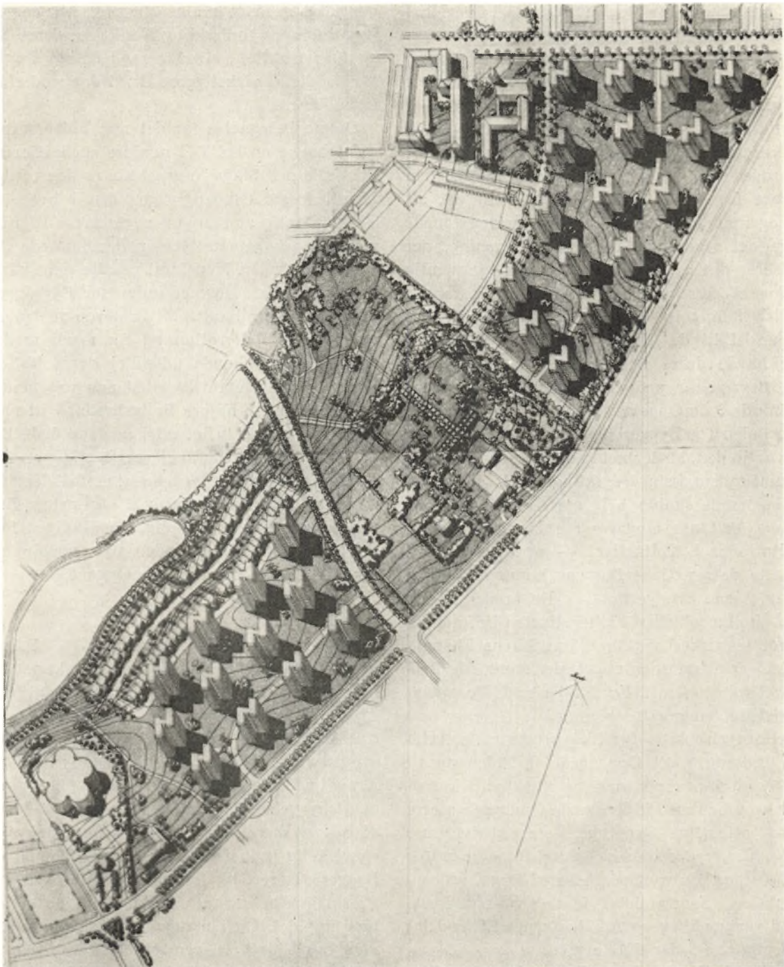
Mogens Irming og Tage Nielsen: Forslag til Bebyggelse paa Bellahøjterrænet, tilkendt Førstepræmie i en Arkitektkonkurrence 1945. 11-Etages Punkthuse placeret i grønne Omraader med stor indbyrdes Afstand.
