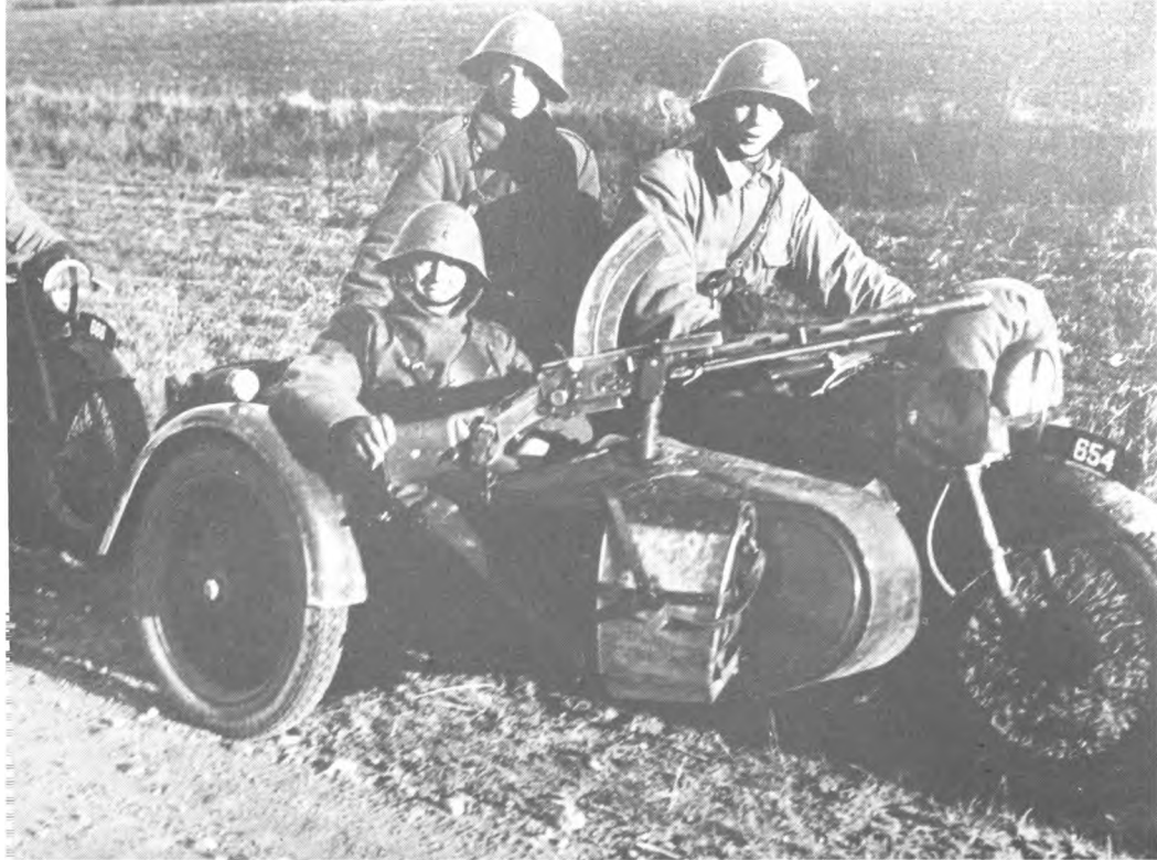
Forsvarets Billed- og Portrætsamling: Privatfoto taget af en rekrut en gang i 1930'erne. Det viser en 20 mm maskinkanon af fabrikatet Madsen monteret på en af de legendariske Nimbus-motorcykler.
