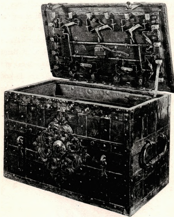
Gammel Pengekiste fra det københavnske Compagni med ikke mindre end 18 Laaserigler, der alle drejes ved een Nøgle i Kistens Laag. Blev anvendt som Pengeskab lige indtil omkring 1890.
