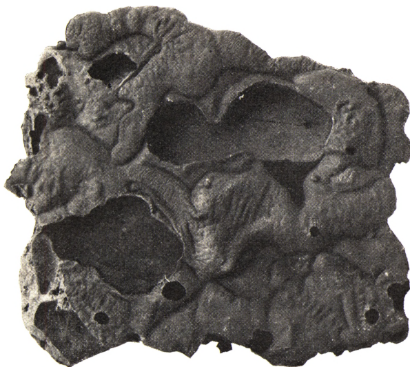
Slagge fra Skoven Nyvænge, V. Aaby Sogn. \frac{1}{2} Størrelse. Gruberne skyldes Luftblærer i den tyndtflydende Slaggemasse. Fra det 14. Aarhundrede.
