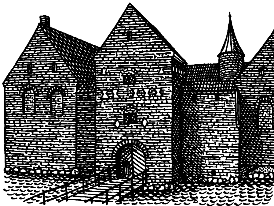
Spøttrup er et typisk dansk eksempel på en gotisk herregård. Med sine tykke og solide mure rejser den sig af voldgraven. Forsvarsmulighederne gik forud for bekvemmeligheden.
