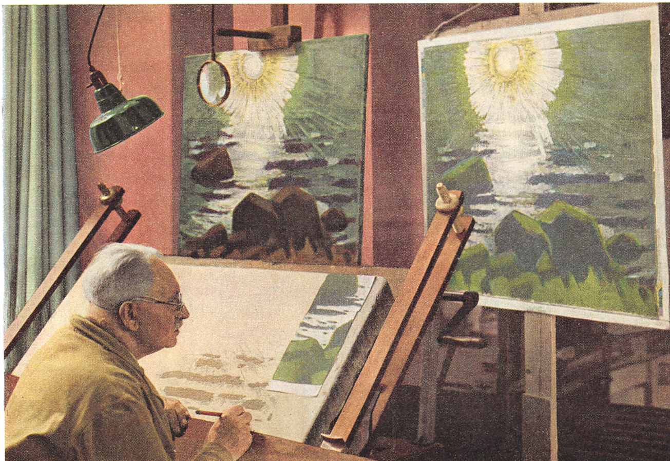
Dansk Litograflaug: Litografen P. W. Johannsen, arbejdende paa et Farvelitografi efter et dansk Kunstværk (Originalen ses til venstre, det halvfærdige Prøvetryk til højre).
