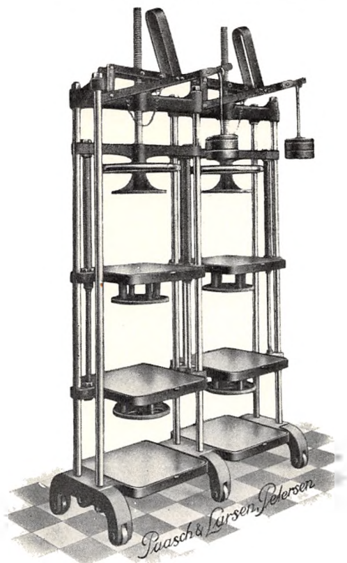
Fig. 149. Osteopresse fra A/S Paasch & Larsen, Petersen, Horsens.
