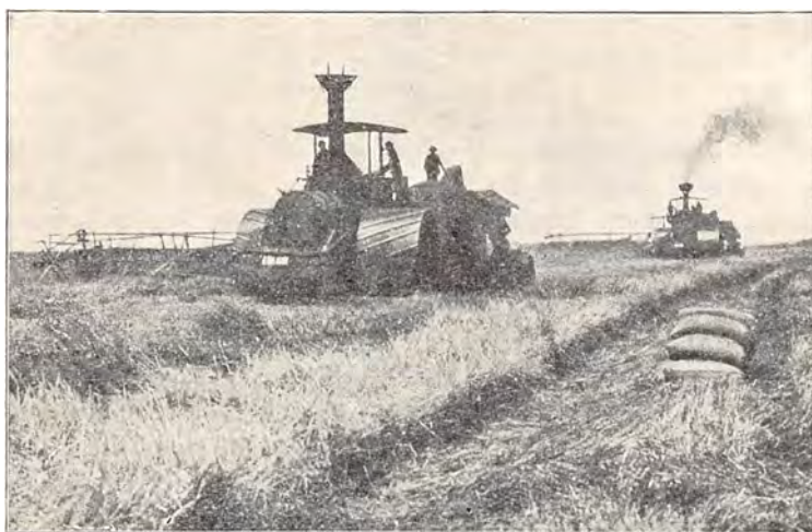
Dampdrevne Høstmaskiner, der mejer, tærsker og renses Kornet og aflægger det i tilbundne Sække paa Marken.
