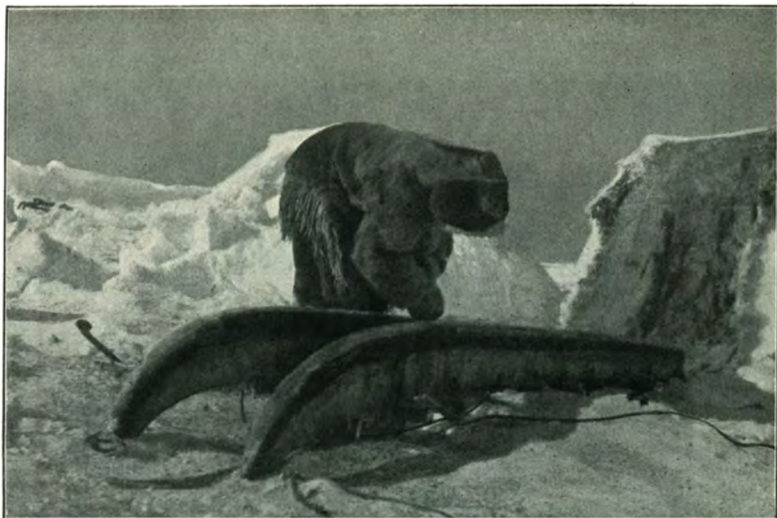
Naar Tørvedejgen er frosset fast til Slædemederne som en bred Ski, maa alle Ujævnheder glattes, enten med en Høvl eller med en skarp Kniv.
