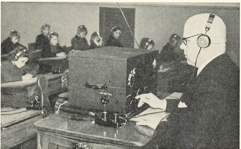
Fig. 3. Audiometeret sender Toner af forskellig Styrkegrad til Børnenes Hovedtelefoner.
