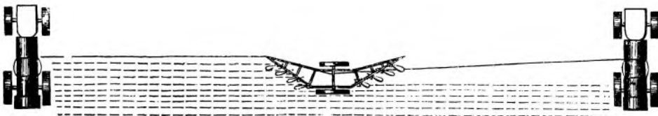
Fig. 169. Fowlers System med 2 Lokomobiler.
