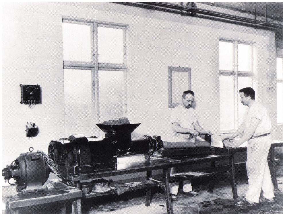
Interiørbillede fra Arbejdernes Aktiebageri i Vindegade i Odense 1911. Rugbrødene skæres ud, og maskinen drives af en motor fra Thomas B. Thrige (Otto Nørmark fot., Odense Centralbibliotek, Lokalhistorisk Afdeling).
