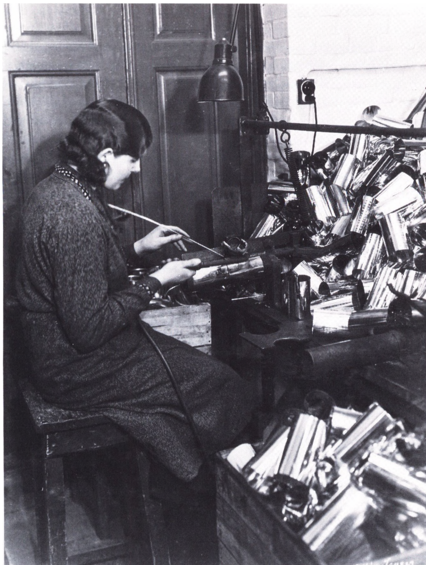
Håndlodning af dåser på Haustrup's Fabrikker i 1920'erne (Ditlev Jensen fot., Odense Centralbibliotek, Lokalhistorisk Afdeling).
