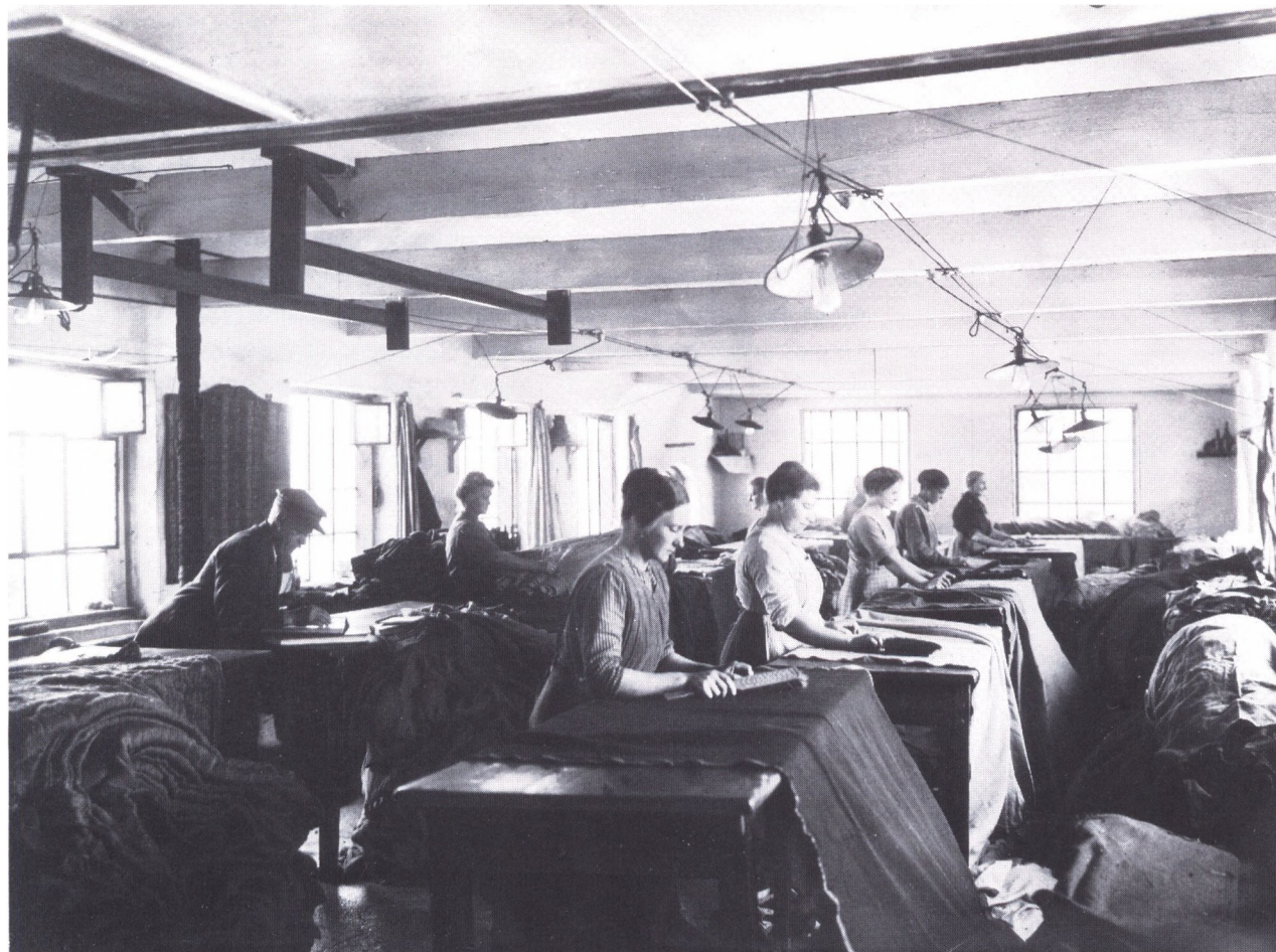
Stoffet noppes og efterses på 1. sal i Brandts Klædefabriks gamle kedelhus 1919 (Odense Centralbibliotek, Lokalhistorisk Afdeling).
