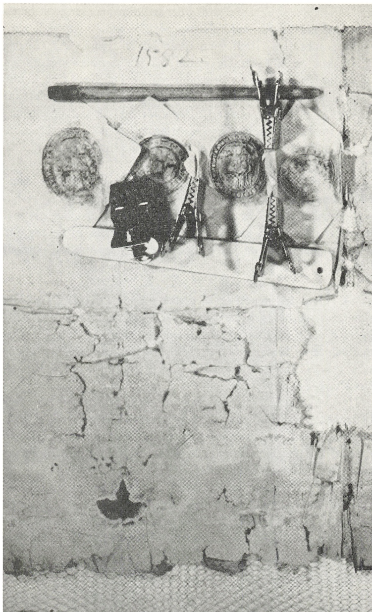
Fig. 4. Del af bagsiden af et papirbrev af 28/4 1582. Stærkt fragmenteret, tydelig misfarvning på grund af svampeangreb, i midten musegnav. En fjerdedel af brevet er blevet konserveret af den spansk-grønt (kobberforbindelse), man har brugt til farvning af den voks, der har været anvendt under oblatseglene, mens resten er ødelagt. Dette understreger nytten af desinfektionen. Et sådant brev skal naturligvis finkonserveres på traditionel vis.
