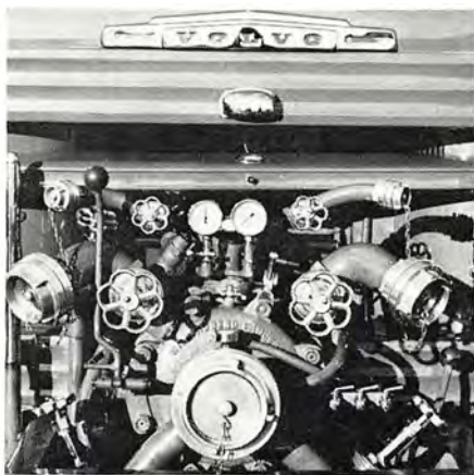
Overtryk kan bl. a. opstå, når vandtanken fyldes gennem frontpumpen.
