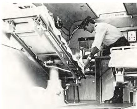
Begge bærer kan indstilles med hydraulisk fodpumpe. Det frembyder utallige elevationsmuligheder.
