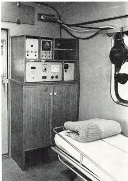
Den rullende genoplivningsafdeling rummer bl. a. en DC-defibrillator, en pacemaker og et oscilloskop, der viser hjertets udslag. Endvidere et aflåst skab med medicinsk udstyr.
