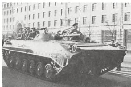
Pansret mandskabsvogn BMP-A. Tre plus otte mand. 13 t. 73 mm kanon, panserværmsrakat SAGGER.
